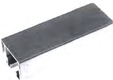
Fig. 1 – Esempio di corrosione da immagazzinamento (foto tratta dalla pubblicazione CIOA Difetti dell'alluminio e dell'alluminio anodizzato )
