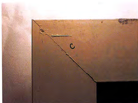
Fig. 4 - Aspetto del nodo sinistro del campione dopo prova di corrosione. Le superfici di taglio non erano state protette prima dell'assemblaggio (dall'archivio fotografico del laboratorio QUALITAL)
